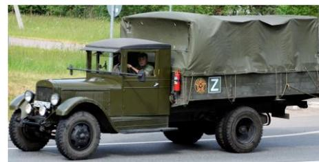
**ЗИС-151** - советский среднетоннажный грузовой автомобиль повышенной проходимости, производившийся в 1948 - 1958 годах на Московском автозаводе имени Сталина. Широко использовался в вооружённых силах. Перестал производиться после выпуска вездехода ЗИЛ-157.
