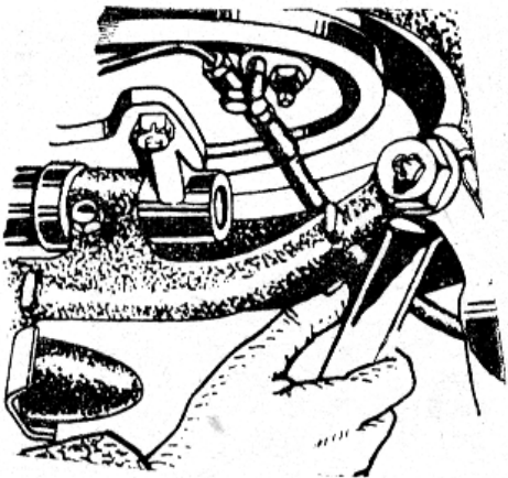
Рис. 53. Регулировка углов вращением верхней втулки.
