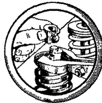
Рис. 20. Снятие сухарей клапана
