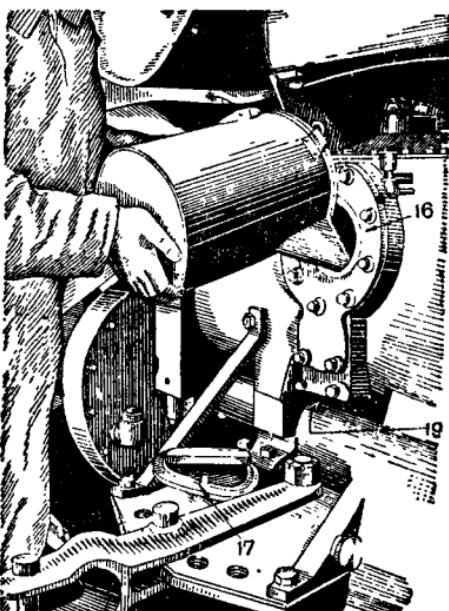
Рис. 95. Заливка масла в отделение конической передачи.
