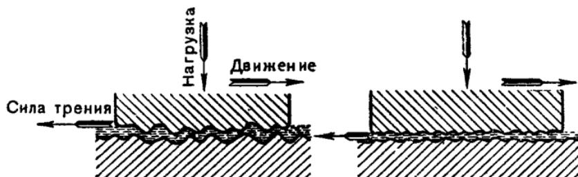
Рис. 69. Трение деталей с различной обработкой поверхностей при работе со смазкой.
