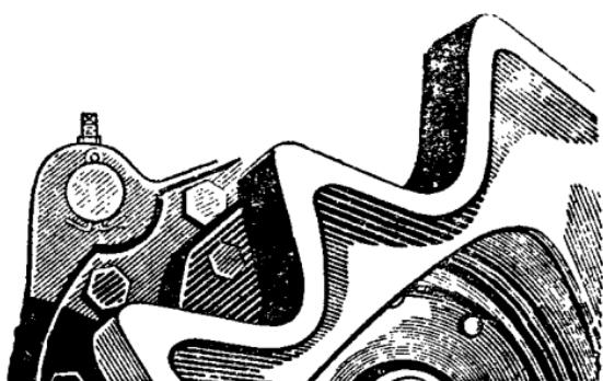
Рис. 106. Крепление пальца стопорного крючка.
